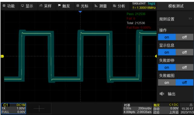
基于硬件的模板测试功能，最高每秒可执行 80000 次测试，适用于长期无人值守监测异常信号
